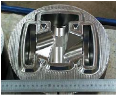
Рис. 25. Пример обработки вставки штампа горячей штамповки. Полная обработка за один установ без полировки. Время обработки 95 мин. Размер вставки 300x145 мм, твердость 51 HRC, подача 5 м/мин, обороты шпинделя 35 тыс. об./мин. Самая малая фреза диаметром 2 мм
