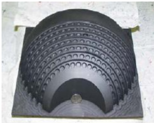
Рис. 26. Пример обработки графитового электрода. Размер 350x200 мм, 9600 шестигранных отверстий с радиусом скругления 0,2 мм. Наружная поверхность обработана шаровой фрезой диаметром 10 мм, черновая обработка отверстий фрезой диаметром 1,5 мм и чистовая обработка отверстий фрезой диаметром 0,4 мм. Обороты шпинделя 45 тыс. об./ мин, время обработки 34 ч
