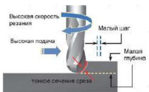
Рис. 2. Режимы резания для традиционной и высокоскоростной обработки
