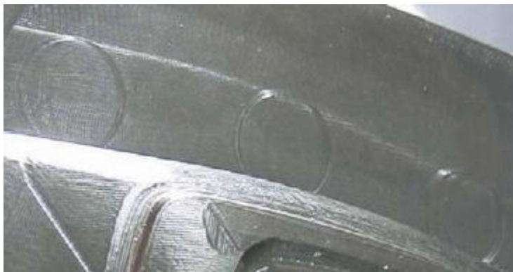
Рис. 5. Следы фрезы в местах остановки
