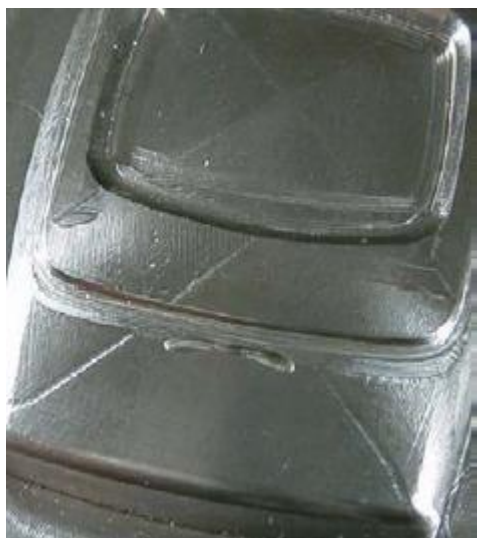
Рис. 17. След инструмента в углах траектории в момент изменения направления обработки
