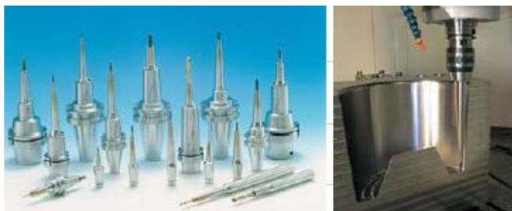
Рис. 8. Оправки для термозажима инструмента
